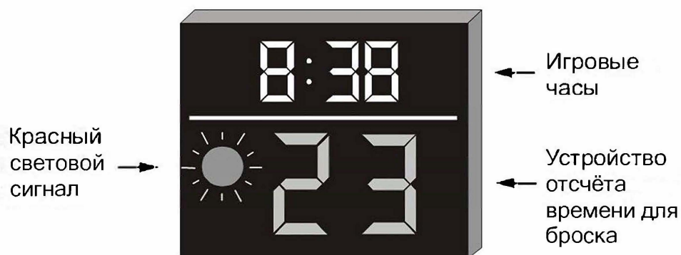
Рис. 9 Дисплей устройства отсчёта времени для броска, дублирующие игровые часы и красный световой сигнал для Уровней 1 и 2 (пример оборудования)
